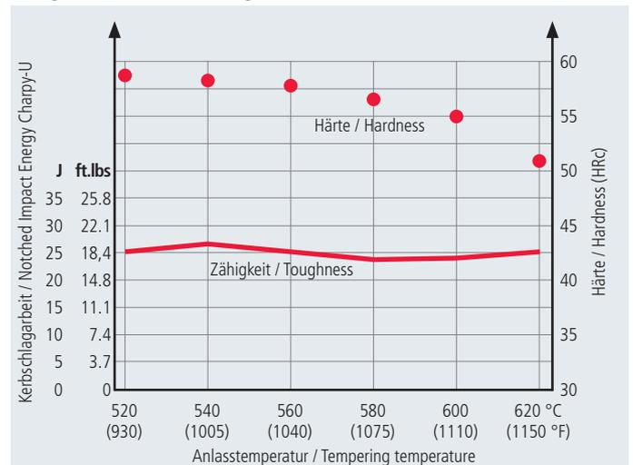
Bei Betrachtung der Zähigkeit in Abhängigkeit der Anlasstemperatur (Härte) zeigt sich, dass die Zähigkeit des BÖHLER W360 ISOBLOC von 51 – 57 HRC nahezu konstant ist. / Looking at the toughness over tempering temperature (hardness) it can be seen that the toughness of BÖHLER W360 ISOBLOC is almost constant from 51 to 57 HRC.
