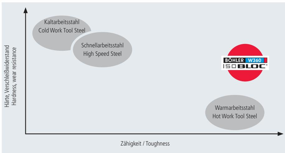
Der **BOHLER W360 ISOBLOC** ist ein vom Markt geforderter Werkstoff, der die Vorteile der hohen Härte eines Schnellarbeitsstahles mit der sehr guten Zähigkeit eines Warmarbeitsstahles in sich vereint. Eigenschaften, welche die Lebensdauer ihres Werkzeuges erheblich verlängern.
