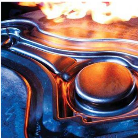
**BÖHLER W360 ISOBLOC** wurde als Werkstoff für Matrizen bzw. Stempel in der Warm- bzw. Halbwarmumformung entwickelt und läßt sich überall dort einsetzen wo eine Kombination aus hoher **Härte** und guter **Zähigkeit** gefragt ist.
