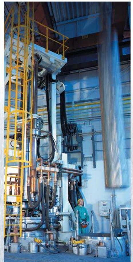
Der Elektro-Schlacke-Umschmelzprozess garantiert höchste metallurgische Reinheit und damit beste Gebrauchseigenschaften.
