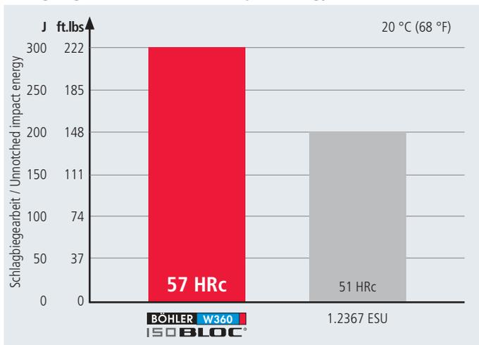
BÖHLER W360 ISOBLOC weist im Vergleich zu 1.2367 ESU bei hoher Härte eine deutlich höhere Zähigkeit auf. / BÖHLER W360 ISOBLOC has a significantly higher toughness than 1.2367 ESU – at a higher hardness.
